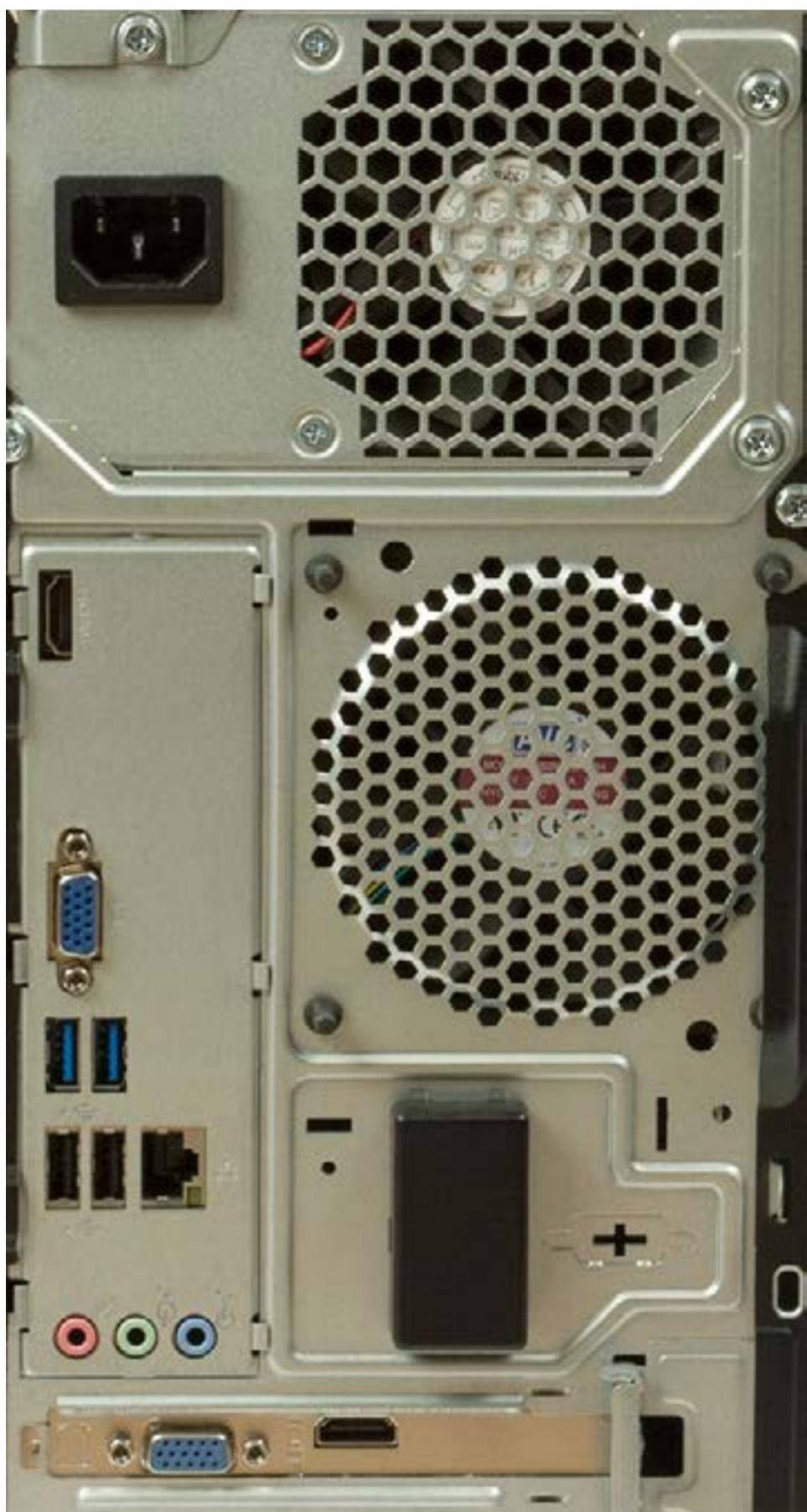
Для проветривания внутрикорпусного пространства предусмотрен всего один пропеллер на задней стенке, и, как показала практика, его вполне хватает для удержания температуры компонентов в разумных пределах. Про-
