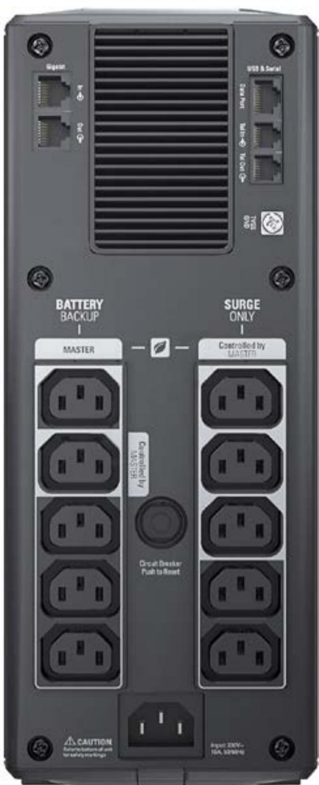
Батарея внутри UPS стоит составная, из двух соединенных последовательно аккумуляторов емкостью 9 Ач и напряжением 12 В, она обеспечивает работу нагрузки мощностью 700 Вт (смешанная из активных и реактивных потребителей примерно 50/50) в течение 3 минут 48 секунд при свежих аккумуля-
