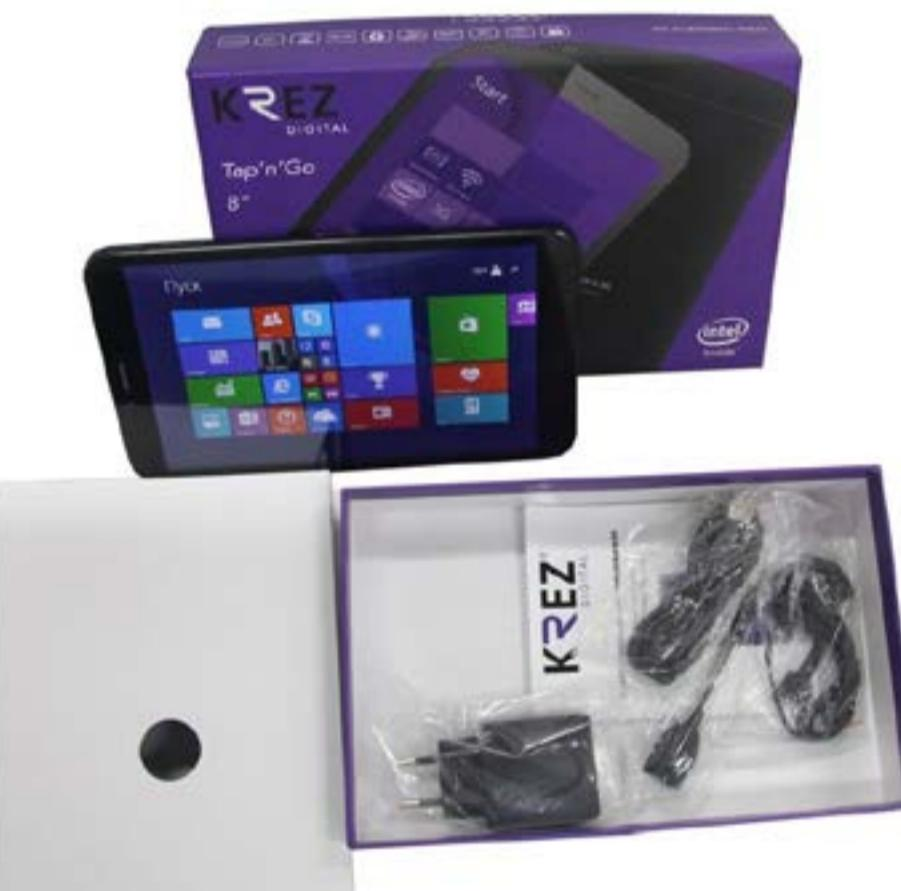
Планшет базируется на процессоре Intel Baytrail-T Z3735G Quad Core с тактовой частотой 1,83 ГГц. Видео – SGX544MP2 OpenGL ES 2.0. Оперативная память – гигабайт, накопитель – 16 Гбайт, есть 3G, Wi-Fi, Bluetooth. Две видеокамеры – фронтальная и еще одна, обе по 2 Мпикс. Аккумулятор – 4000 мАч.
