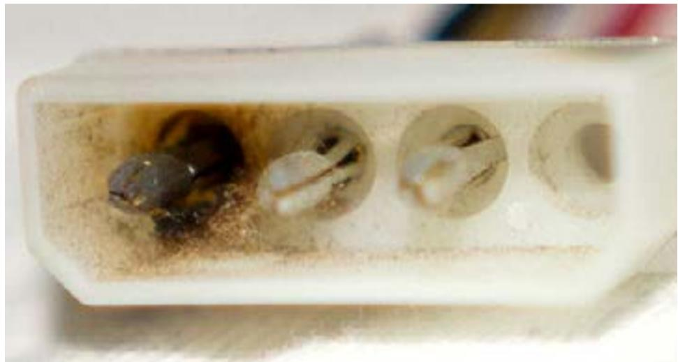
Или (тоже вариант) беда с контактами в разъеме, из-за чего может быть ситуация, когда блок выдает стабильные напряжения, но до потребителей они доходят нестабильно и с значительными просадками. Измерять в загрузке, тыкая (очень аккуратно!) щупами в материнскую плату, использовать возможность фиксировать минимальный и максимальный показатель (если мультиметр так умеет). Это позволит
