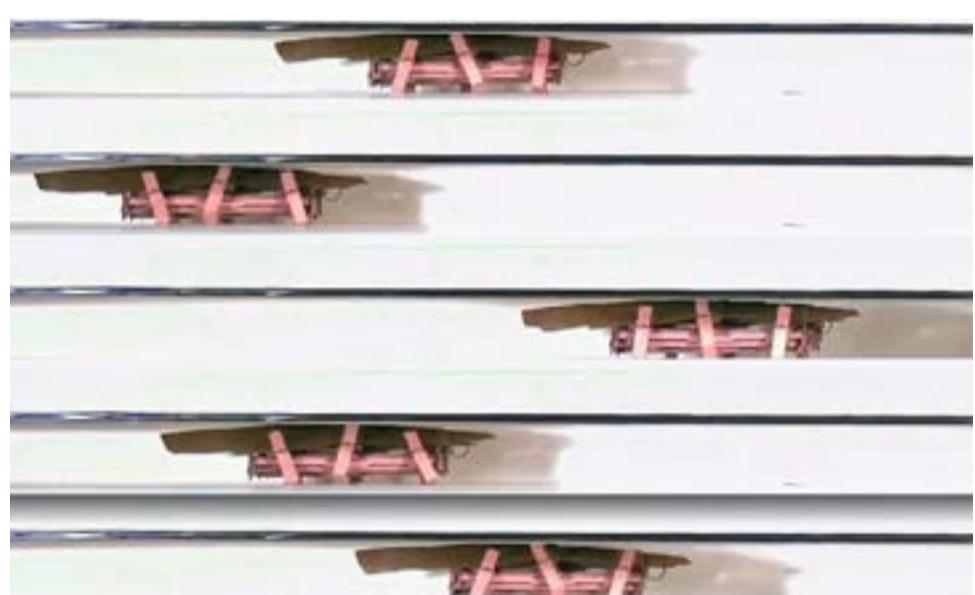
Назвали CRAM – типа, сжимаемый робот с шарнирным механизмом. И теперь его испытывают, загоняя в щели, и радуются – работает! Получился адски прочный проныра, которого дотестируют, доработают, потом нашпиггают хитрой электроникой, размножат и будут засылать на всякие завалы, во всякие воздуховоды, просветы между трубами, кабелями и под дверь к неблагонадежному элементу.
