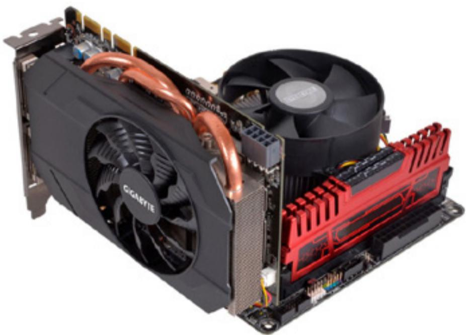
Карта двухслотовая, оборудована фирменной охлаждающей системой WindForce с медными тепловыми трубками и 10-сантиметровым вентилятором. Интерфейсы все видно на картинке. Карточка чуток разогнана: 1076 МГц – ядро и 1216 МГц – память. Ну и вкусная цена: \$330.
