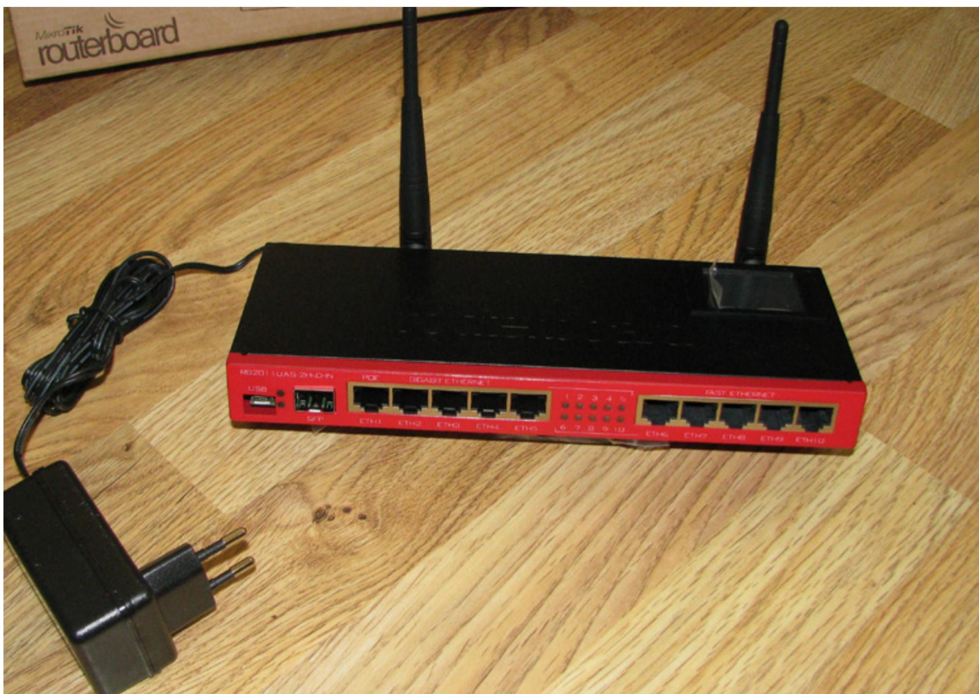
Adaptive Noise Immunity – ap and client mode (патентованная фича Atheros для игнорирования мусора в эфире). В закладке HT включаем вторую antennу (chain1) на передачу и на прием. Ну и главное, в закладке Tx Power выставляем allrates fixed и снижаем мощность до 14 дБм. 17 дБм – это номинальная мощность домашних роутеров, 0,1 Вт, MikroTik по умолчанию кричит на 27 дБм, дома это не нужно, получается переусиление и миниатюрная микро-
